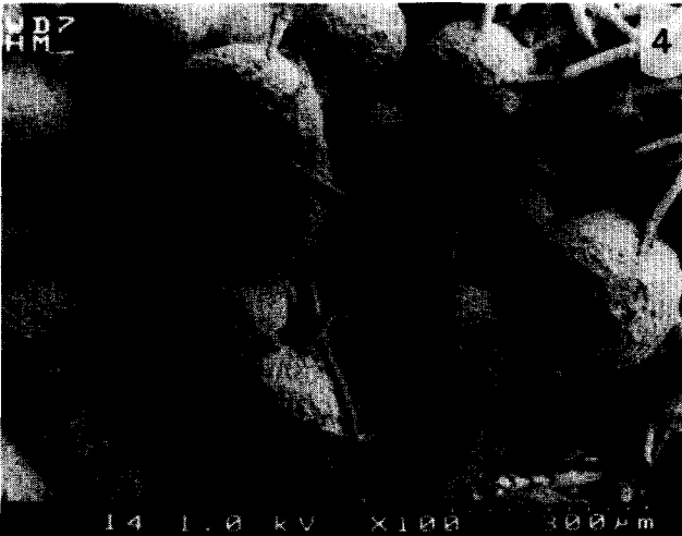
Figure 4. Aspect au cryo-Mebec de l'échantillon de la figure 3 après réhumectation, au même grossissement, sans métallisation.
