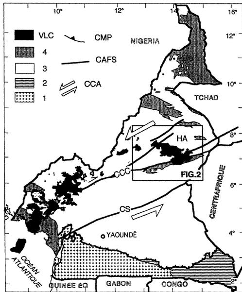
**Figure 1.** Croquis géologique du Cameroun. 1 : groupe archéen du Ntem; 2 : couverture protérozoïque; 3 : chaîne panafricaine; 4 : dépôts phanérozoïques. VLC : volcanisme et plutonisme de la ligne du Cameroun; CMP : chevauchement majeur panafricain; CAFS : système de faille d’Afrique centrale (CS, cisaillement de la Sanaga; CCC, cisaillements centro-camerounais); CCA : mouvement du méga-cisaillement cénozoïque à actuel; HA : horst de l’Adamaoua.
