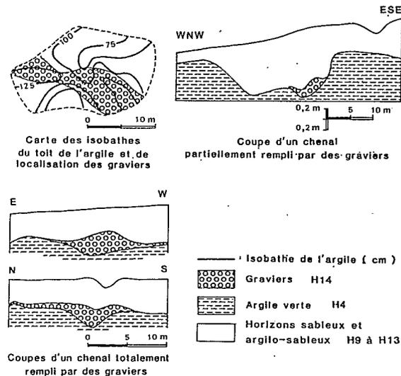
Figure 6 : Coupes de deux chenaux remplis par des graviers (cf. fig. 3).
