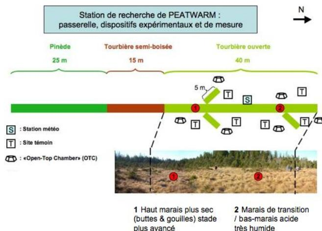
**Fig 1 : le dispositif de mesures prévu à Frasne pour 'Peatwarm'**
