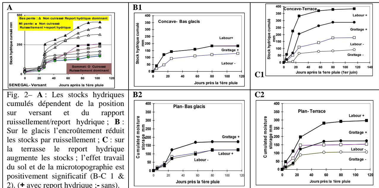
Fig. 2– **A** : Les stocks hydriques cumulés dépendent de la position sur versant et du rapport ruissellement/report hydrique ; **B** : Sur le glacis l’encroûtement réduit les stocks par ruissellement ; **C** : sur la terrasse le report hydrique augmente les stocks ; l’effet travail du sol et de la microtopographie est positivement significatif (B-C 1 & 2). (+ avec report hydrique ; - sans).
