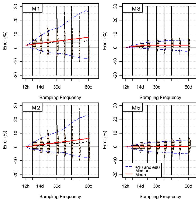
Figure 2. Distribution idéalisées des erreurs ( $\epsilon$ ) sur les flux annuels de nitrate, PO<sub>4</sub>, Ptot, et Ppart=Ptot-P-PO<sub>4</sub> pour la Loire à Orléans (fréquence mensuelle) [1]
