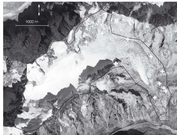
Figure 3 : Orthophotoplan du glacier Blanc obtenu à partir des prises de vues du 2 octobre 2002. Les croix blanches sont les points utilisés pour le calage des 3 couvertures aériennes de 1952, 1981 et 2002. Le trait noir indique la limite des terrains restitués pour obtenir le modèle numérique de terrain de référence.
