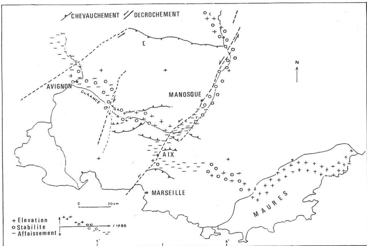
Figure 3 - CARTE INTERPRETATIVE DES MOUVEMENTS VERTICAUX DE LA PROVENCE DEDUITE DES PROFILS DE NIVELLEMENTS d'après FOURNIGUET (1977) in COMBES (1984)
