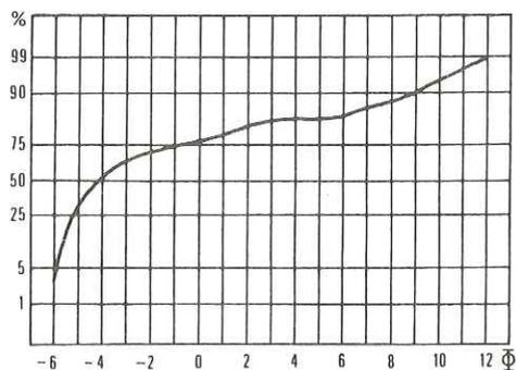
Fig. 4. - Courbe cumulative des Cailloutis de St-Etienne-du Bois. L'échantillon analysé provient de l'affleurement de Meillonas au lieu-dit la Raza.
