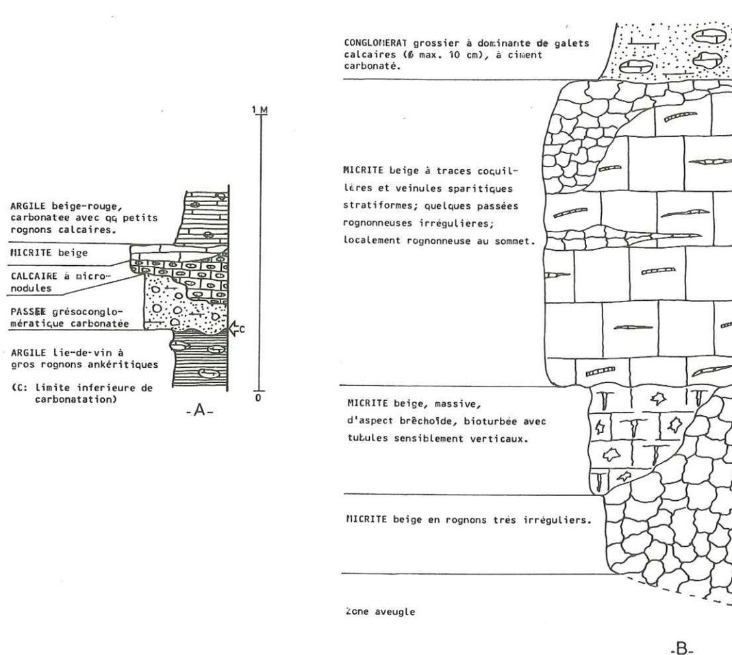
Fig. 6: HORIZONS CALCAIRES DE LA COUPE DES GEISSIERES
