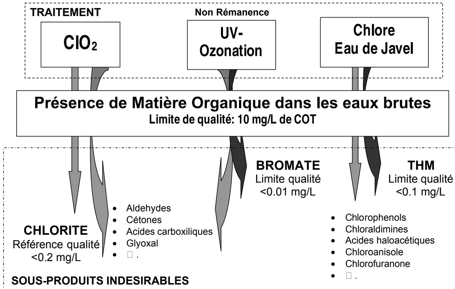
**Figure 1** : Schéma résumant les nombreux sous-produits toxiques susceptibles d'être générés lors de la désinfection chimique d'eaux riches en MO. Seuls les traitements physiques de type membranaire, par ailleurs très coûteux, peuvent palier ce problème.
