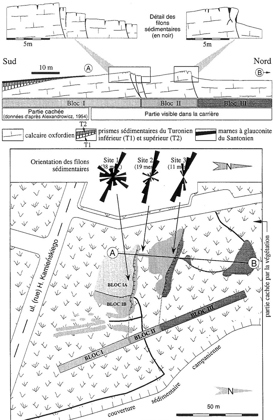
**En bas**, plan de la carrière de Bonarka et des trois petits blocs basculés (I, II et III) et orientation des filons sédimentaires à remplissage Santonien mesurés sur trois sites.
