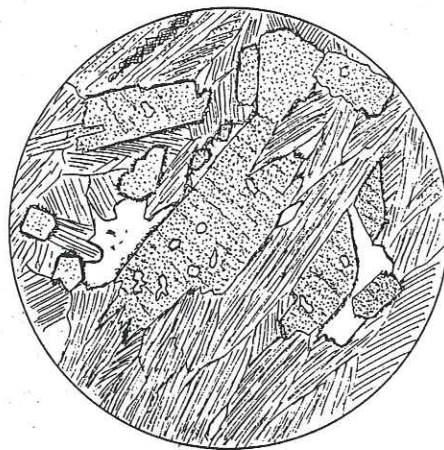
Fig. 41. Amphibolite de la Zone de Siviez: amphibole vert pâle, pistachite en grands cristaux bordés d'actinote, albite. Les Beutsons.
