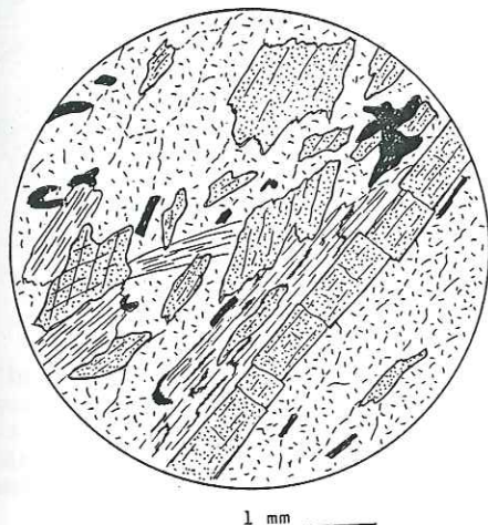
Fig. 20. Niveau foncé dans les gneiss rubanés: grandes aiguilles d'amphibole, chlorite et oxydes dans une matrice de plagioclase séricitisé. Plan du Pey.
