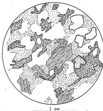
Fig. 114. Plagioclase séricitisé avec amphibole, épidote, quartz et apatite. Col du St. Bernard.
