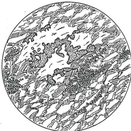
Fig. 48. Amphibolite claire: dans une pâte de hornblende et de chlorite, de l'albite, du sphène et de l'épidote en grains minuscules. Arête W du Rogneux, 2940 m.
