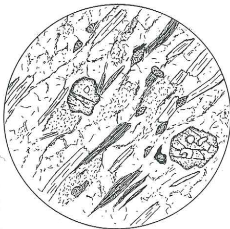
Fig. 38. Gneiss clair. Quartz, albite, épidote, mica blanc, biotite, grenat, min. opaques. Crête de Servay.
