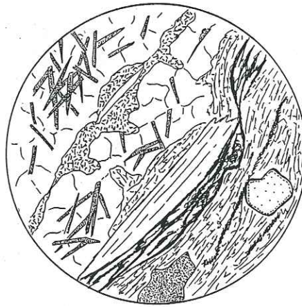
Fig. 13. Matrice des gneiss ocellés: biotite altérée, séricite, chlorite, mica blanc en grandes lamelles, apatite, quartz, stilpnomélane. Mt. Brûlé.
