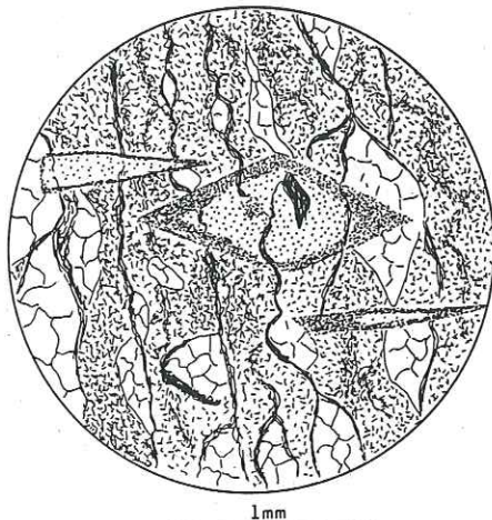
Fig. 129. Cristaux de glaucophane transverses à la schistosité et bordés d'actinote. Fond de quartz et séricite. Lacerandes.
