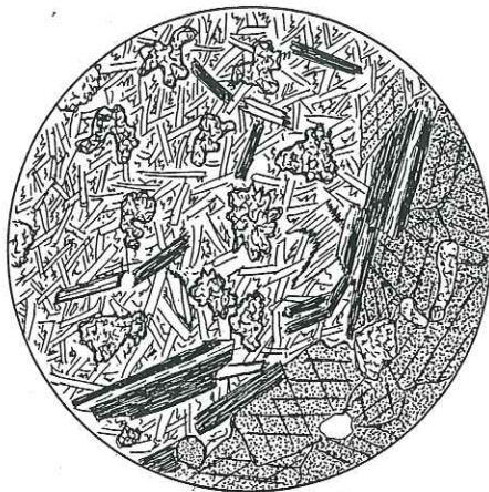
Fig. 125. Altération d'un grenat: biotite, chlorite, mica blanc, albite, épidote. Fournoutse.
