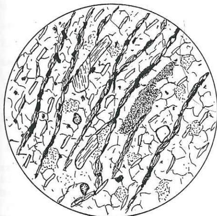
Fig. 14. Niveau de quartzite massif: quartz, albite, chlorite, mica blanc, amas foncé substitué à une biotite (ou amphibole?), apatite. Route de la Niord.
