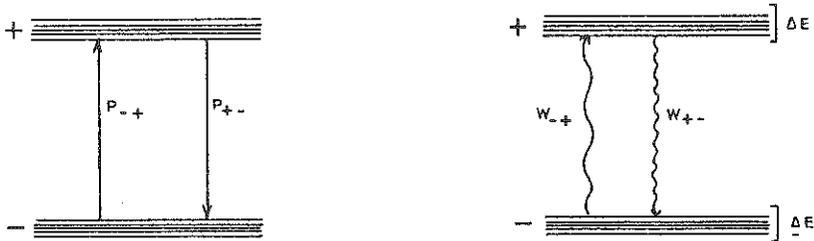
Fig. 4. Transitions induites par le champ magnétique,  $P_{-+} = P_{+-}$ . Transitions spin-réseau,  $W_{-+} = \exp(E/KT)W_{+-}$ . La largeur  $\Delta E$  des niveaux magnétiques est proportionnelle à  $1/T_1$ .
