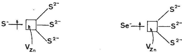
Fig. 16. Trou piégé par un ion  $S^{2-}$  dans ZnS (ou  $Se^{2-}$  dans  $ZnS_{1-x}Se_x$ ) au voisinage d'une lacune de cation. L'électron célibataire occupe une orbitale  $p_z$  de l'anion, pointant vers la lacune, la symétrie générale du défaut étant  $C_{3v}$  autour d'un axe trigonal  $(111)$  du cristal.
