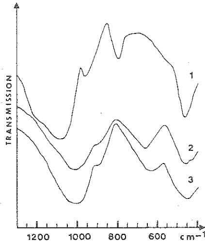
Fig.9 - Spectres infrarouge de gels de composition \text{SiO}_2 \text{MO}, n\text{H}_2\text{O}
