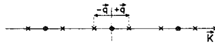
Figure 25 : Figure de diffraction d'une chaîne hélimagnétique dont l'ordre magnétique est décrit par le vecteur d'onde q (comme pour la figure 13, les réflexions de Bragg nucléaires et magnétiques sont représentées respectivement par des points et des croix).
