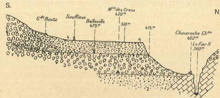
Fig. 3. — Coupe entre la moraine au Sud de Souffieux et le Fier, à travers le cône fluvio-glaciaire. — Longueurs, 1/30.000 ; hauteurs exagérées 5 fois. — 1, Calcaire urgonien. — 2, Alluvions interstadias wurmiennes. — 3, Moraine du retrait wurmien. — 4, Alluvions fluvio-glaciaires (cône et terrasse).
