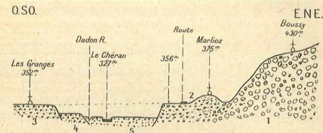
Fig. 7. — Coupe entre Boussy et les Granges à travers le cône fluvioglacière de Marlioz et le Chéran. — Longueurs, 1/30.000; hauteurs exagérées 5 fois. — 1, Moraine de Boussy (retrait wurmien). — 2, Cône de transition de Marlioz. — 3, Terrasse des Granges-Rumilly (wurmienne de retrait). — 4, Terrasse néowurmienne. — 5, Alluvions modernes.
