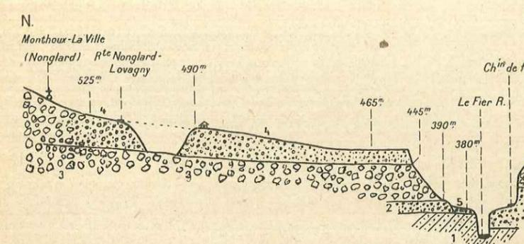
Fig. 2. — Coupe entre La Ville (Nonglard) et le Fier. — Longueurs, 1/30000e; hauteurs exagérées 5 fois. — 1, Mollasse burdigalienne. — 2, Alluvions interstadières wurmiennes. — 3, Moraine du retrait wurmien. — 4, Alluvions fluvio-glaciaires (cône de transition). — 5, Terrasse inférieure.
