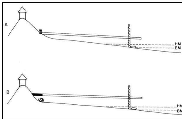
Fig. 5 – Mesure d'érosion par la méthode des points de repère.
