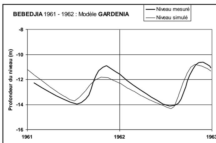
Fig. 2 – Bebedjia. Modélisation des niveaux piézométriques 1961-1962.
