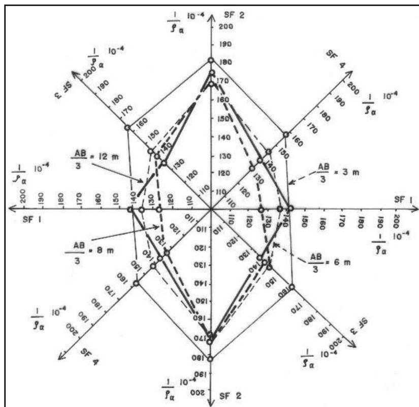
Fig. 4 – Etude de la fissuration (sondages électriques pluridirectionnels) / Fracturing study (multi-directional electrical soundings).
