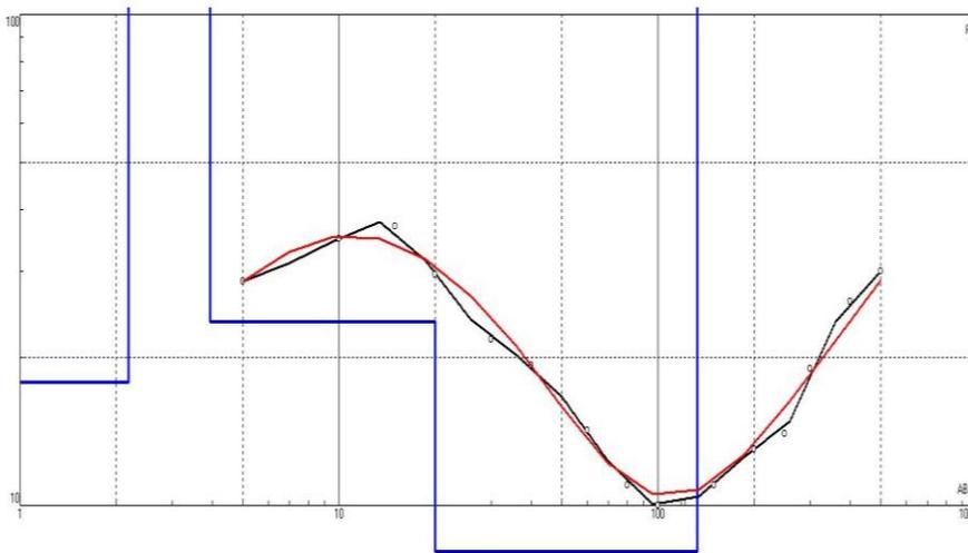
Figure 3 : Courbe géo-électrique du sondage électrique SE28-L2N
