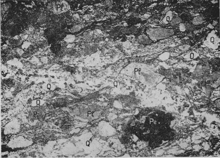
Fig. 1. — Mylonite de la carrière de Moulins (G \times 20). Q, quartz; Mi, microcline; Pl, plagioclase; Mu, muscovite; Pe, perthite.
