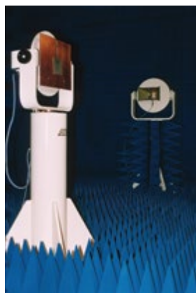
← Mesures automatisées en chambre anéchoïque des caractéristiques d'antennes imprimées isolées ou en réseau
