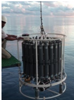
↑ Rosette CTD : couronne de bouteilles de prélèvement d'eau de mer
