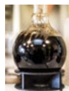
← Bio-bitume obtenu après liquéfaction hydrothermale
