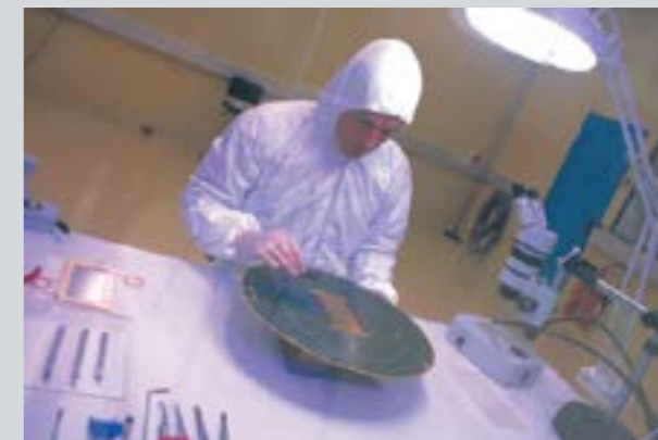
Assemblage d'un détecteur à haute résolution spatiale, type MICROMEGAS, conçu pour déterminer les trajectoires des photons, utilisé notamment pour les expériences ALICE au CERN
