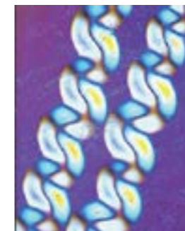
Couches minces fonctionnelles de molybdène sur la face métallisée d'un miroir
