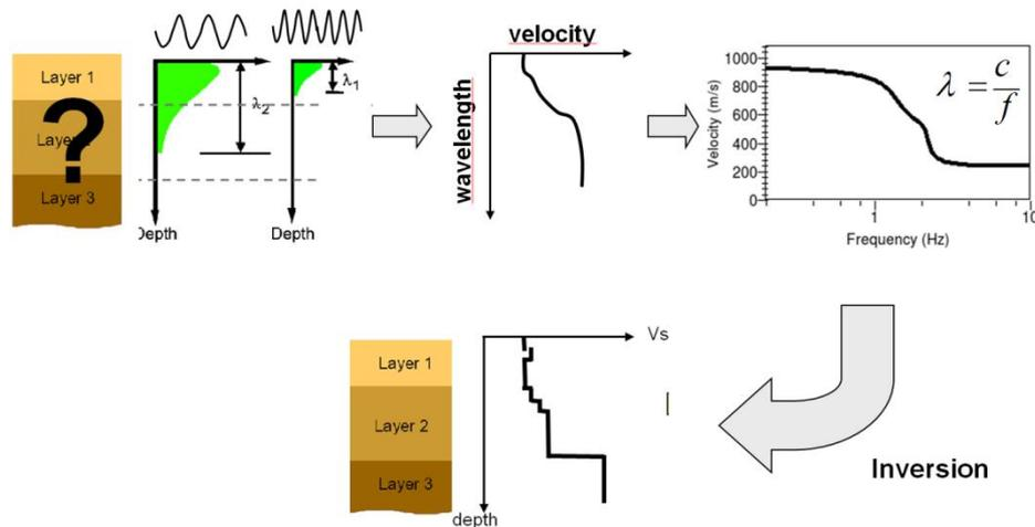
**Figure 2.** *Principe d'acquisition et de traitement des méthodes dites « non-invasives » basées sur la détermination de courbes de dispersion des ondes de surfaces, puis leur inversion en profils de vitesse.*
