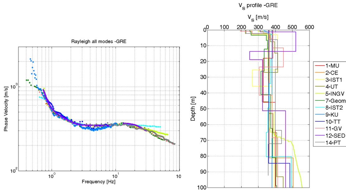
**Figure 5.** Résultats du traitement et de l'inversion des données non-invasives pour le site de Grenoble (« stiff soil »). A gauche : courbes de dispersion obtenues. A droite : profils de vitesses résultant de l'inversion.
