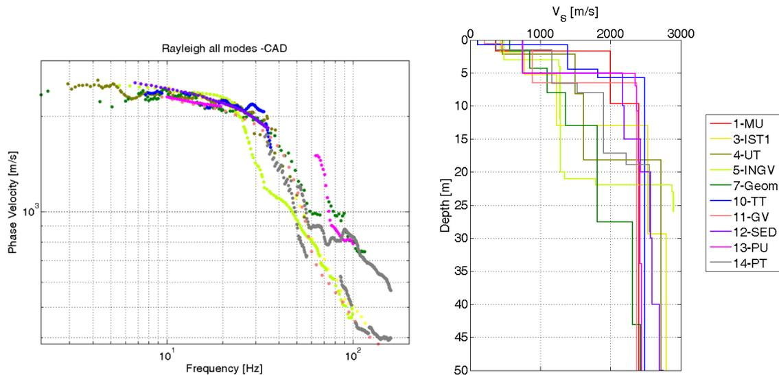
**Figure 6.** Résultats du traitement et de l'inversion des données non-invasives pour le site de Cadarache (« hard rock »). A gauche : courbes de dispersion obtenues. A droite : profils de vitesses résultant de l'inversion.
