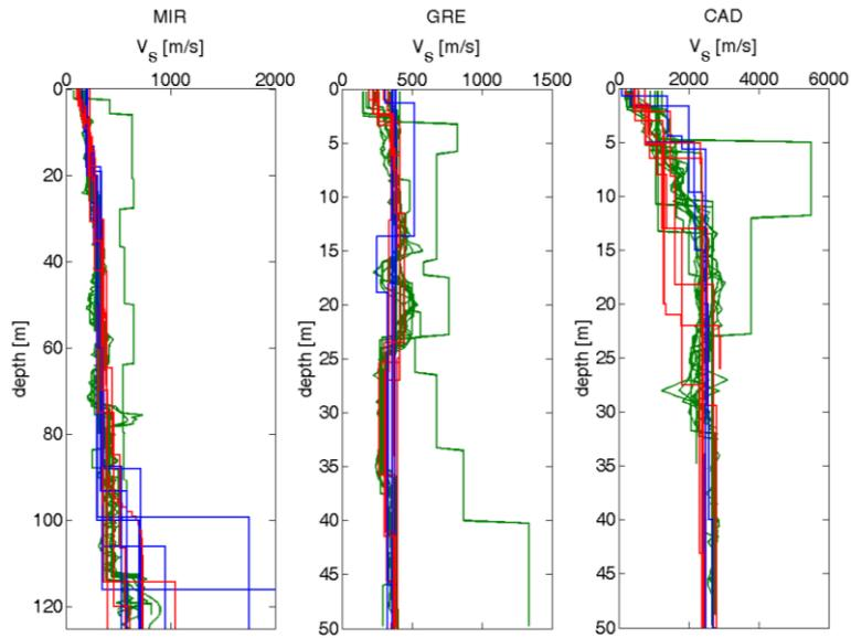
**Figure 7.** Comparaison des profils de vitesse obtenus avec les méthodes invasives (vert) et non invasives (rouge : utilisation conjointe des données passives –AVA– et actives –MASW– ; bleu : utilisation des données passives –AVA– uniquement) pour les trois sites-test.
