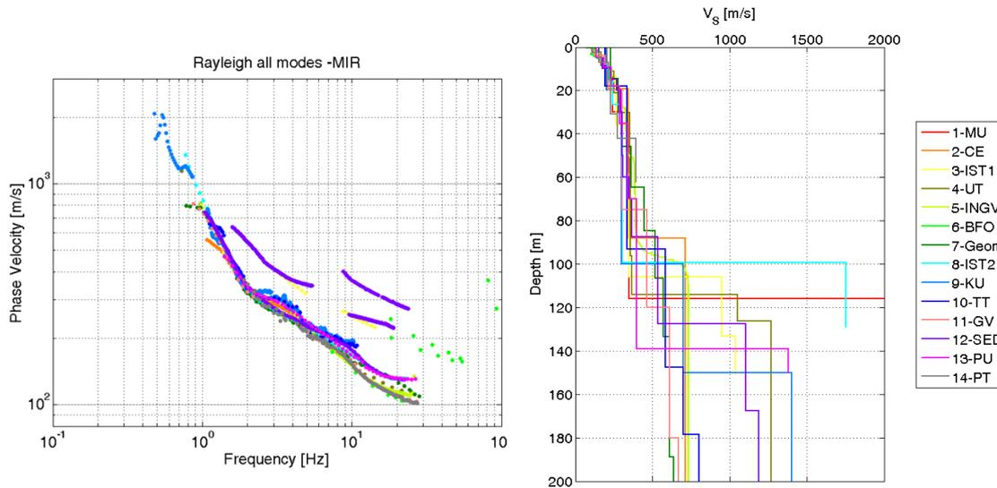
**Figure 4.** Résultats du traitement et de l'inversion des données non-invasives pour le site de Mirandola (« soft soil »). A gauche : courbes de dispersion obtenues. A droite : profils de vitesses résultant de l'inversion.
