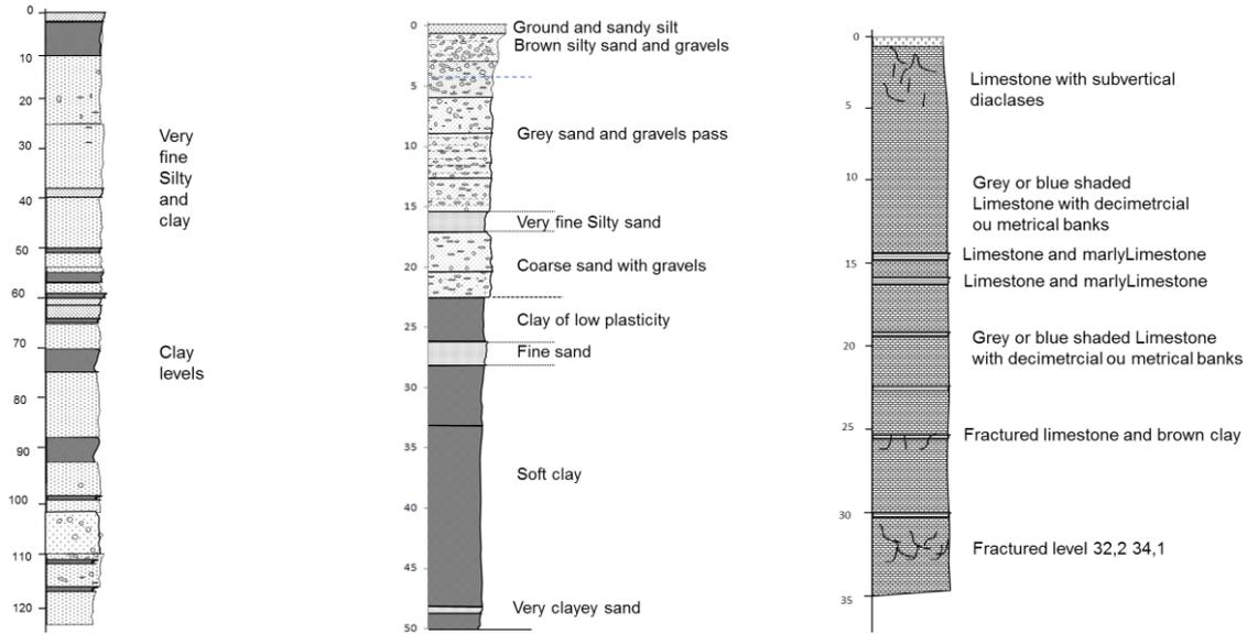
Figure 3. Logs lithologiques des trois sites tests. De gauche à droite : Mirandola, Grenoble, Cadarache.
