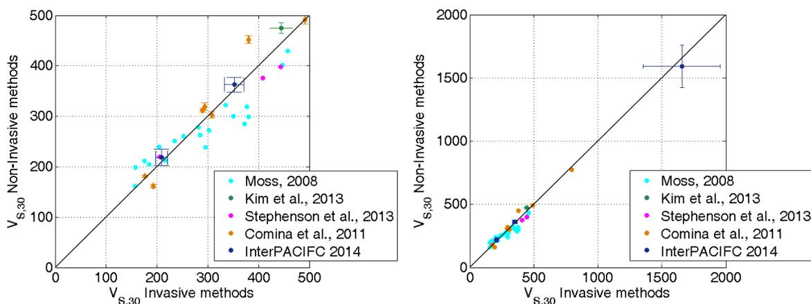
**Figure 10.** Comparaison des résultats obtenus dans le cadre du benchmark InterPacific avec d'autres études confrontant  $V_{s,30}$  issus de méthodes invasives et non-invasives.
