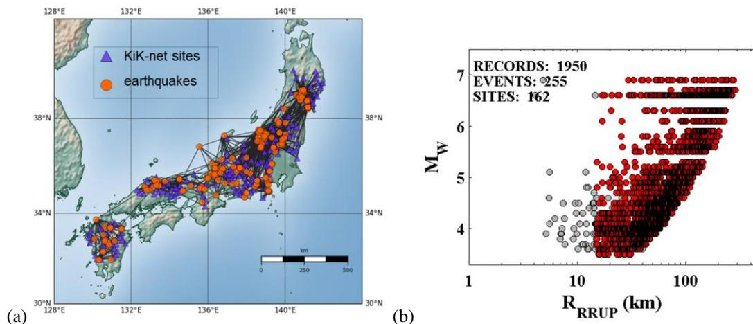
**Figure 1.**(a) Séismes et stations utilisés dans cette étude ; (b) Distribution des magnitudes de moment  $M_w$  et des distances à la rupture  $R_{RRUP}$  des enregistrements KiK-net sélectionnés dans cette étude.
