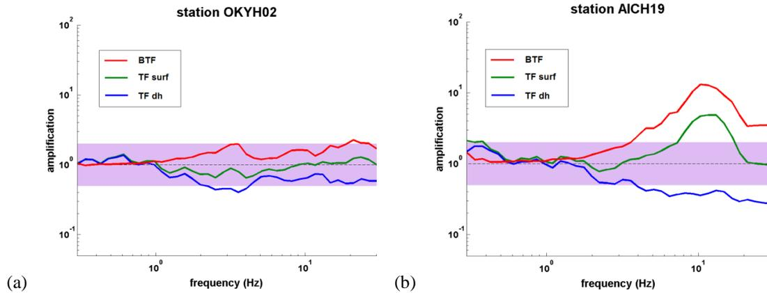
**Figure 4.** Exemples de fonctions de transfert de site obtenues à partir de l'inversion généralisée en surface (lignes vertes) et en profondeur (lignes bleues) pour (a) OKYH02 et (b) AICH19. Les rapports entre les fonctions de transfert de surface et de profondeur sont représentés avec les lignes rouges. La zone violette correspond aux niveaux d'amplification entre 0.5 et 2 et permet de mettre en valeur l'amplification de site.
