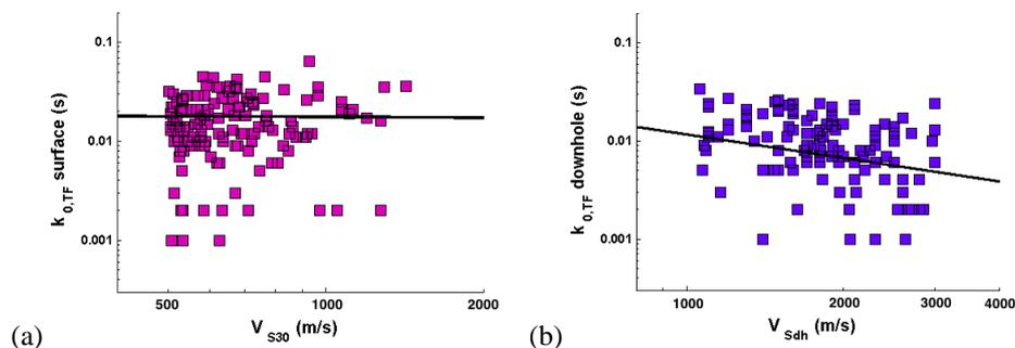
**Figure 7.** (a) Valeurs de  $\kappa_0$  en surface en fonction des valeurs de  $v_{S30}$  ; (b) Valeurs de  $\kappa_0$  en profondeur en fonction des valeurs de  $v_S$  en fond de puits. Les lignes noires montrent la régression linéaire des données.
