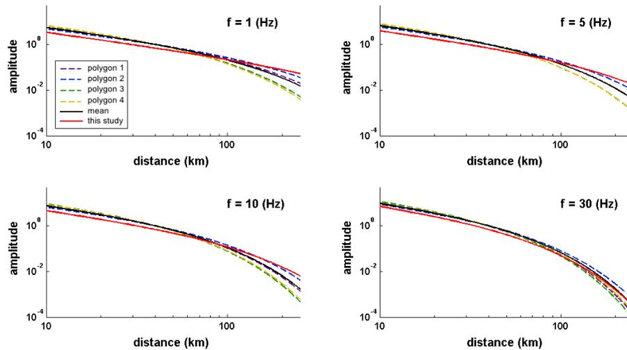
**Figure 2.** Modèles d'atténuation à partir des valeurs de  $Q_0$  et  $\alpha$  de Oth et al. (2011) et des paramètres d'atténuation inversés, pour quatre fréquences différentes (1, 5, 10 et 30 Hz) en fonction de la distance.
