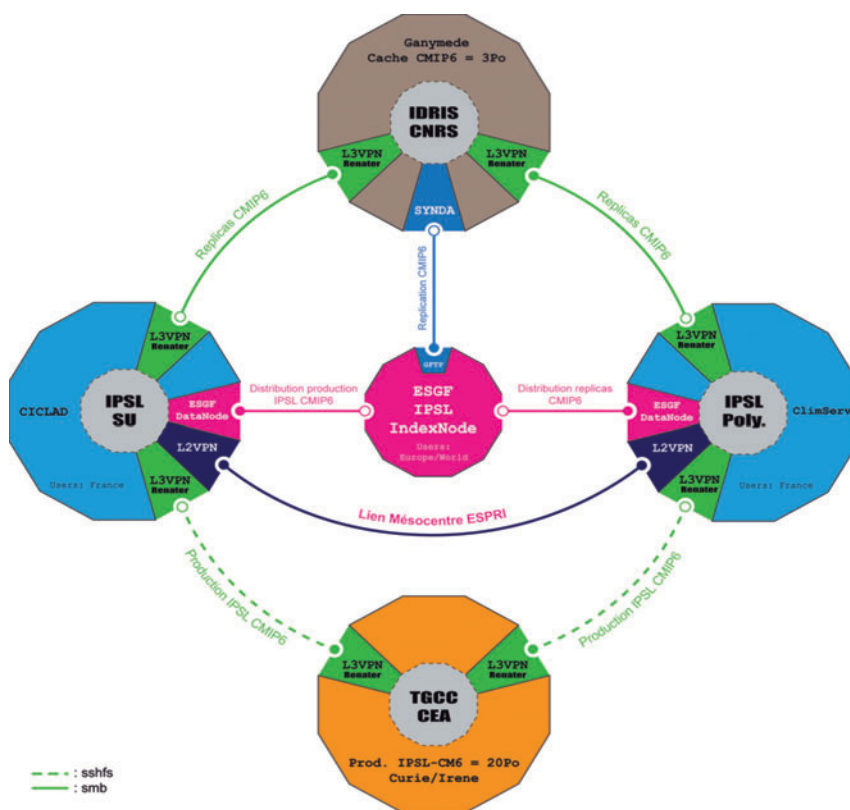
Figure 1. Architecture de l'infrastructure de calcul et de distribution des données servant au Centre de modélisation du climat de l'IPSL. Le mésocentre de calcul de l'IPSL permettant d'analyser les données climatiques est relié aux centres de calcul nationaux IDRIS-CNRS et TGCC-CEA. Le nœud de distribution ESGF s'appuie également sur le stockage de masse positionné dans les deux centres de calcul. © Guillaume Levavasseur, Sorbonne Université.
