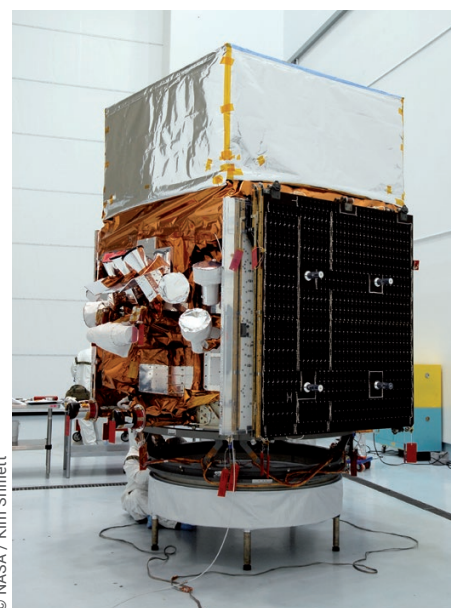
1. Le satellite Fermi avant le lancement. Le LAT est le gros parallélépipède gris au sommet. On voit les modules du GBM (disques blancs) sur le côté gauche du module de services.
