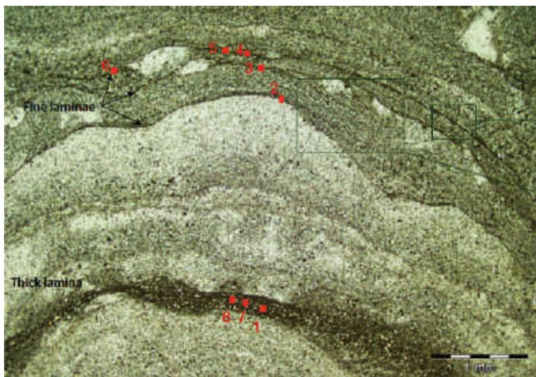
Analyse *in situ* par NanoSIMS (carrés rouges) des isotopes du soufre de nanopyrites présentes dans des lamelles carbonées (5 à 20 microns d'épaisseur) enduites à la surface de stromatolithes de la Formation Tumbiana (Australie occidentale) âgée de 2,7 Ga. L'étude confirme une origine biotique des nanopyrites en accord avec une participation active de la réduction microbienne du sulfate dans le cycle biogéochimique du soufre au Néoarchéen.
