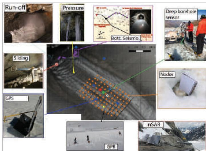
Déploiement de 100 nodes sismiques et 5 stations GPS des parcs mobiles INSU sur le glacier d'Argentière dans le cadre du projet RESOLVE (PI F. Gimbert et P. Roux, <https://resolve.osug.fr/>), complété par des mesures de glissement au fond du glacier (sliding), GPR (Ground Penetrating Radar), InSAR sol, des forages profonds, des sismomètres sur le lit du glacier (bott.seismo.), des piézomètres (pressure) et des mesures de débit (runoff).
