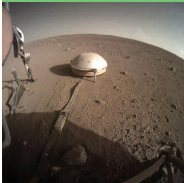
Image du sismomètre SEIS recouvert par son écran WTS (Wind and Thermal Shield) prise par la caméra embarquée ICC (Instrument Context Camera) le 30 décembre 2019 au Sol 388 de la mission InSight
