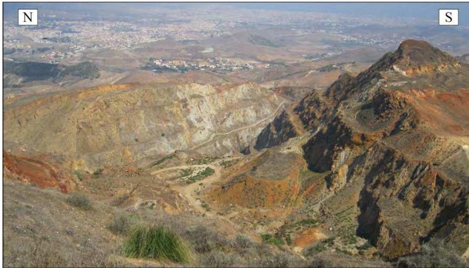
Figure 6.1 : panorama sur l' open pit oriental de Ouiksane. Le parement nord est constitué de l'Intrusion Centrale (granodiorite en clair), le parement sud de l'encaissant.
