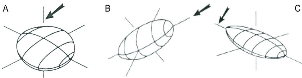
图 4-9 磁组构椭球体的形态类型: (A)压扁型; (B)拉长型; (C)偏长型
