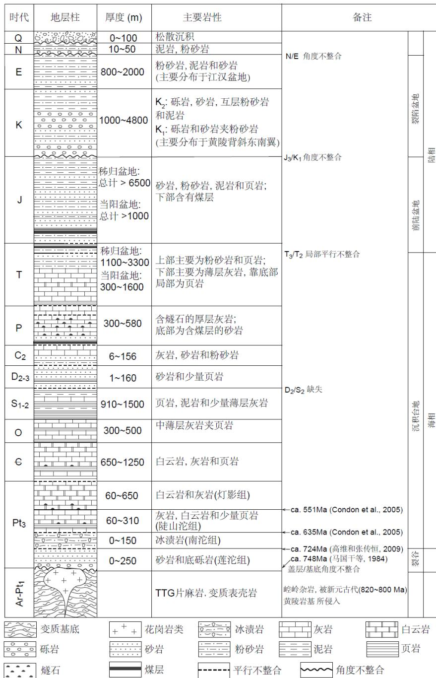
图 5-4 黄陵背斜地区沉积地层柱状图
