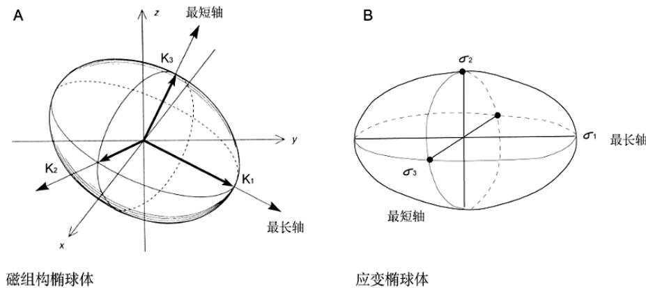
图 4-8 磁组构椭球体与应变椭球体
