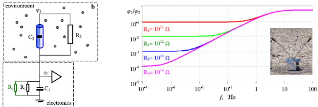
**Fig. 3.1.1.3** A gauche, un schéma simplifié du couplage électrique: électronique SDA - électrode - environnement. A droite, la variation du potentiel mesuré normalisé sur la valeur du potentiel de l'air non perturbé en fonction de la résistance de l'air  $R_2$ .
