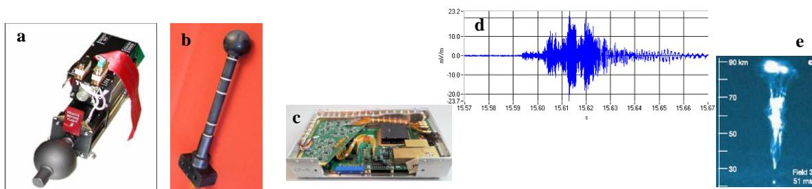
**Fig.3.2.1.1** (a) Capteur IME-BF monté sur son bras déployable; (b) Sonde SI; (c) L'analyseur ; (d) Signal engendré par des décharges atmosphériques et observé dans l'ionosphère (ICE/Demeter); (e) Image d'un blue jet.
