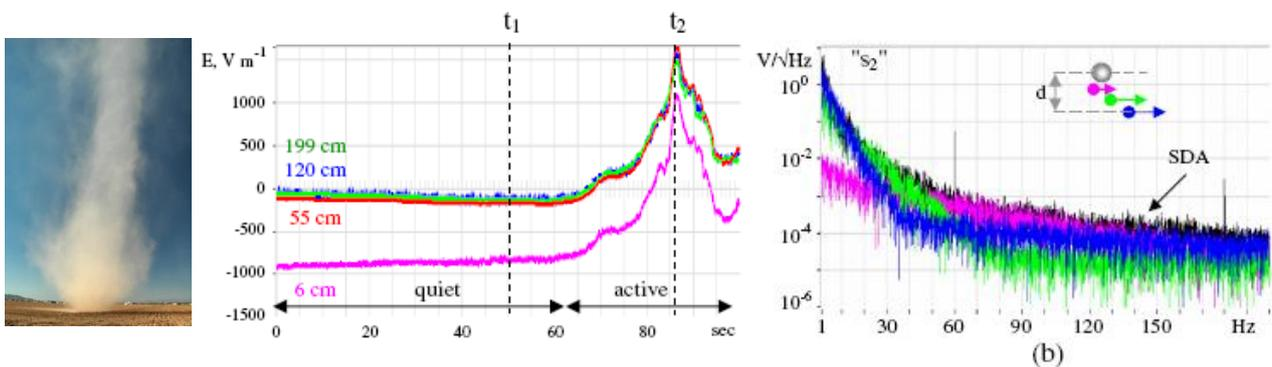
**Fig. 3.1.4a** (à gauche) Tornade de poussières observée dans le désert du Nevada. (au centre) Variation du champ électrique vertical mesurée à quatre hauteurs par rapport au sol lors d'un passage de tornade. (à droite) Spectres du champ électrique lors d'un passage de tornade mesurés (en noir) et modélisés (en couleur).
