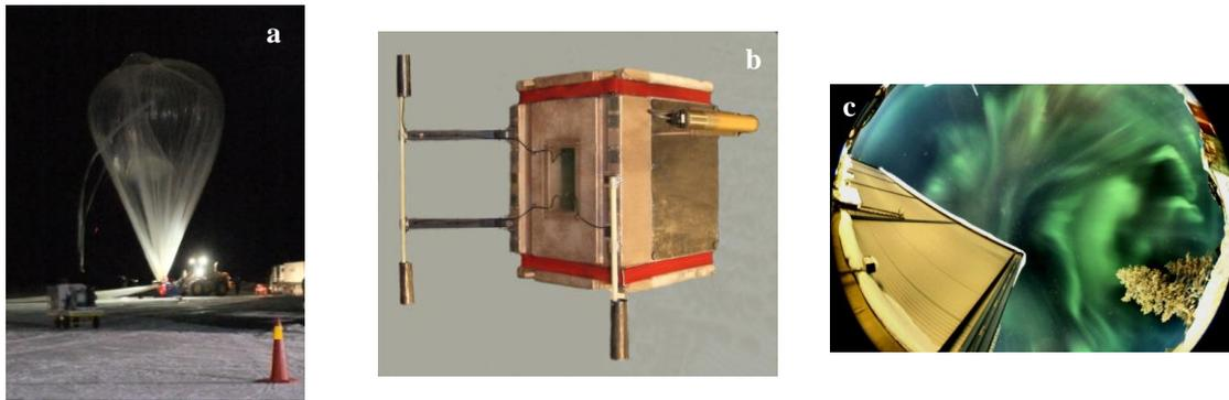
**Fig.3.2.4.2** (a) Préparation du lancement du ballon stratosphérique « Zero- Pressure », Esrange, 2011; (b) Nacelle LDLE-GO avec deux instruments, i.e. SDA et FM. (c) Image de l'activité aurorale effectuée par la camera ALFA pendant le vol LDLE-GO, Mars 2011
