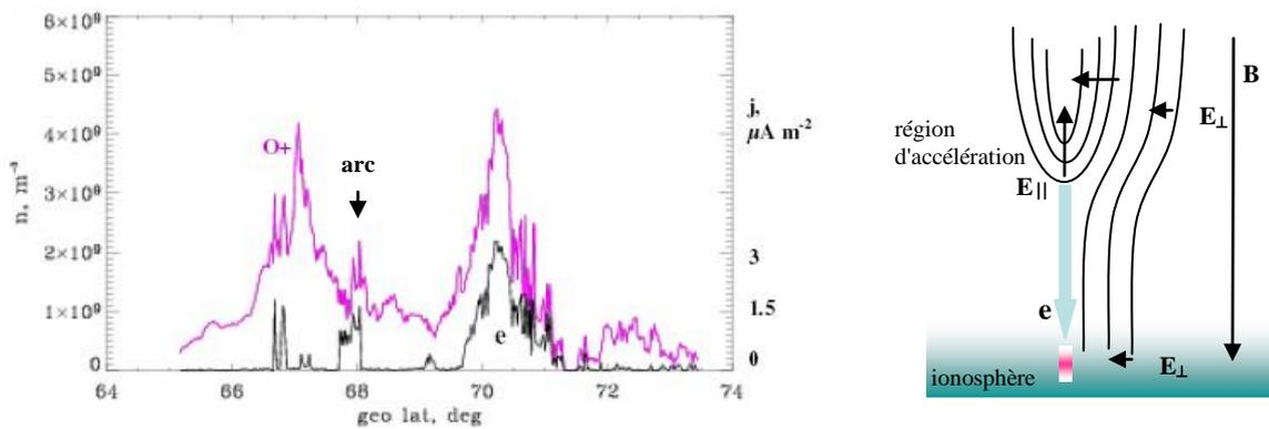
**Fig. 3.1.2.1b** (a gauche) Variations du courant électronique et de la densité des ions oxygène calculées à partir des mesures de l'analyseur d'ions IAP à bord de Demeter. (A droite) Schéma simplifié de la distribution des l'équipotentielles entre la région de l'accélération et l'ionosphère.
