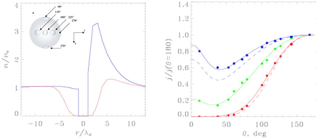
**Fig. 3.1.1.2a** Résultats de modélisation d'une sonde sphérique dans le plasma ionosphérique [Séran et al., 2005a]. **A gauche**, la distribution de la densité des ions 'oxygène (bleu) et des électrons (rouge) dans la gaine autour de la sonde. **A droite**, la variation du courant sur la surface de la sonde sphérique en fonction de l'angle latitudinal par rapport à la direction de la vitesse des ions dans le plasma thermique.
