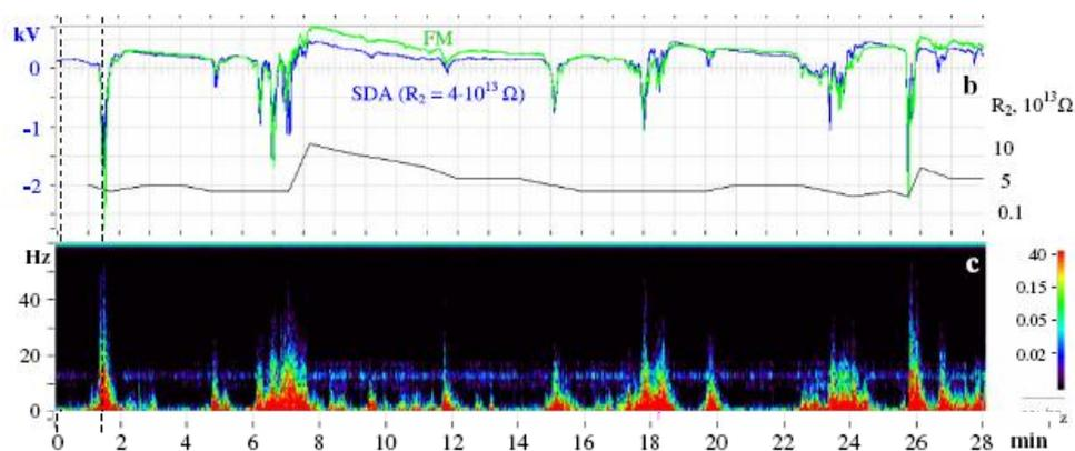
**Fig. 3.1.4b** (b) Variations temporelles du potentiel électrique calculées à partir des mesures des deux instruments, FM (vert) et SDA (bleu), ainsi que la résistance de couplage électrique entre les électrodes de SDA et l'air. (c) Spectrogramme obtenu à partir des mesures SDA. Chaque augmentation de l'amplitude du potentiel correspond au passage d'une tornade.
