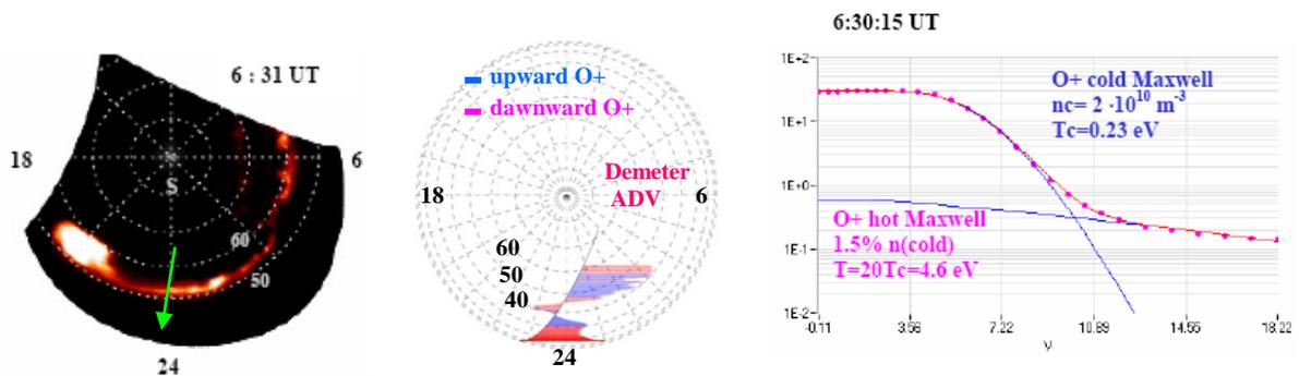
**Fig. 3.1.2.2a** (a gauche) Image d'ovale auroral obtenue par la camera WIC à bord d'IMAGE. (au centre) Vitesse du plasma dans l'ionosphère mesurée par l'analyseur d'ions ADV/DEMETER. (à droite) Le courant mesuré par l'analyseur à potentiel retardateur APR/DEMETER (cercles en rouge) et le courant calculé à partir du modèle développé par Séran [2003] avec deux populations d'oxygène, i.e. thermique et suprathermique (en bleu).
