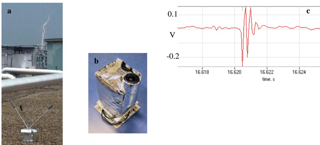
**Fig.3.2.3.2** (a) instrument de mesures du champ électrique SDA sur la toit de l'UPMC; (b) instrument optique OwensCam; (c) les variations du potentiel électrique observé par SDA et générées par un éclair d'orage à 90 km
