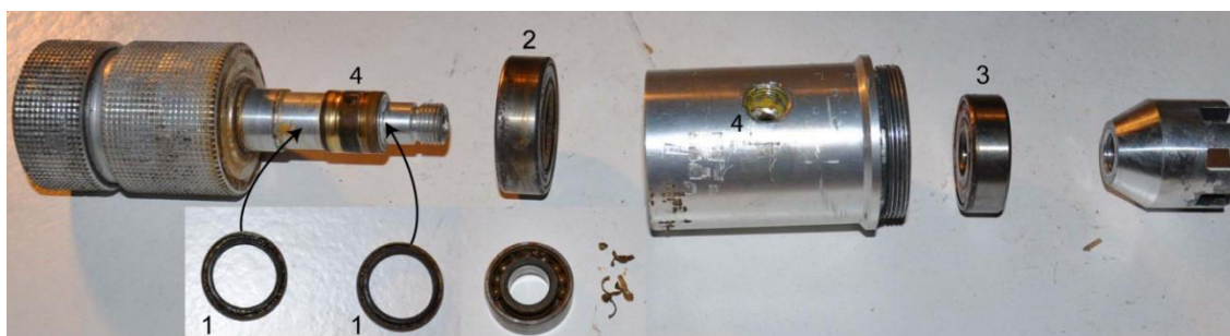
Figura A2.4: Interior del adaptador de la perforadora. 1: Orrines; 2 y 3: Rodamientos (2a: detalle del rodamiento agriparado); 4 y 5: sistema de lubricación, en 4 va la llave hacia la manguera, en 5 se observa un orificio por donde sale el agua hacia el interior de la broca. El agua pasaba hacia los rodamientos debido a la corrosión de los orrines. Una vez el agua llegó a los rodamientos era cosa de tiempo para que estos se agripararan, especialmente si era agua salada, como en nuestro caso.
