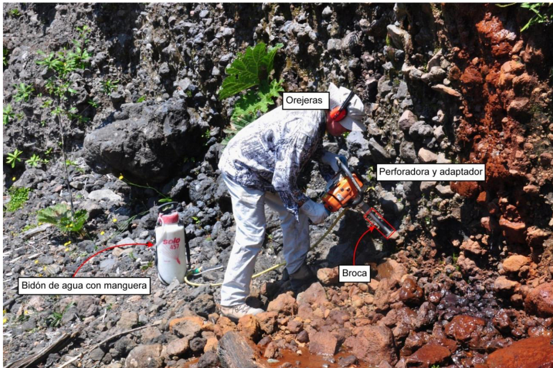
Figura A2.1: Arriba) Moto sierra stihl original y perforadora para paleomagnetismo. Existen otros modelos, como por ejemplo, con taladros eléctricos. Abajo) foto de afloramiento (en una región más cálida, para no congelar a los lectores) donde se muestran los distintos elementos utilizados en la perforación.
