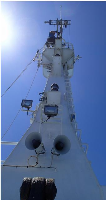
*Figure 3.7: Mât flux instrumenté sur l'Atalante durant AMOP 2014*
