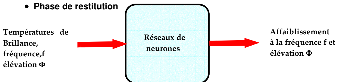
Figure 3 : synoptique du modèle d'estimation de l'affaiblissement atmosphérique par réseaux de neurones
