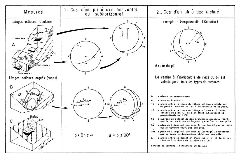
Fig.32 : Méthodes de restitution tectonique pour les différentes structures sédimentaires mesurées.
