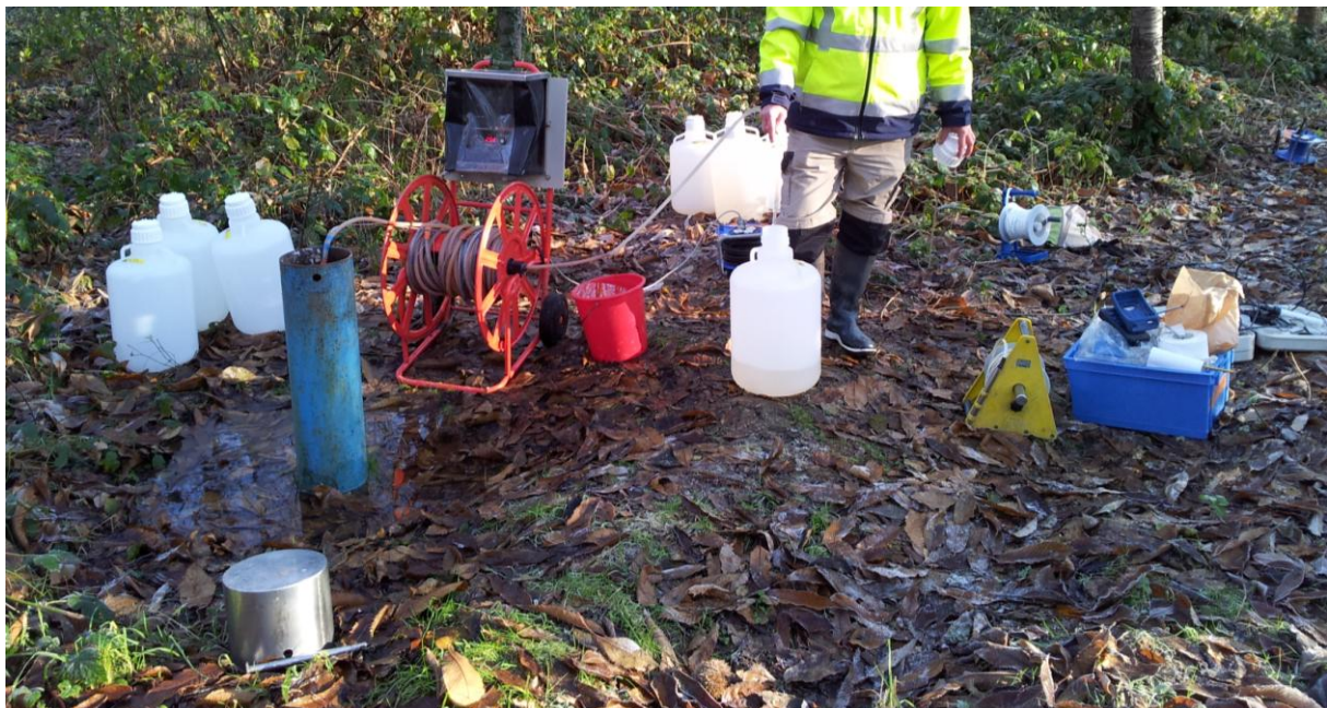
Figure 2.6 Illustration du dispositif de pompage de l'eau souterraine pour des prélèvements de chimie et de microbiologie.
