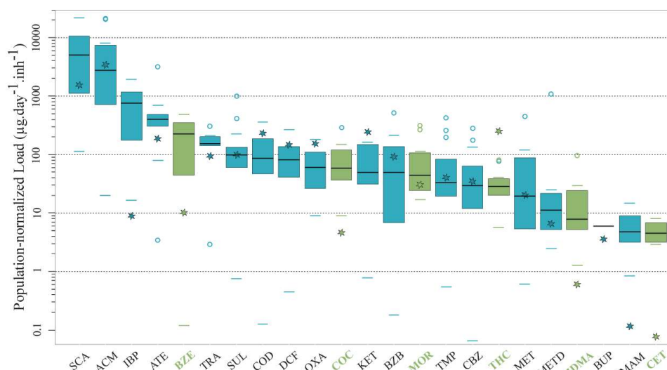
Figure 39 : Comparaison des charges en médicaments et drogues dans les eaux usées en amont d'une STEP de la région Centre, normalisées à la population (étoiles), avec celles d'autres bassins versants issues de la littérature (Thiebault et al., 2017).
