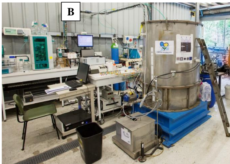
Figure 15 : [A] Représentation schématique du mésocosme instrumenté LABBIO de la plateforme PRIME (d'après Thouin et al. , 2017). [a] colonne en acier, [b] atmosphère contrôlée, [c] litière organique, [d] sol contaminé, [e] géotextile, [f] gravier, [g] alimentation en eau, [h] lampes LED, [i] système d'arrosage, [j] bougies poreuses, [k] sondes TDR (température et humidité relative), [l] niveau d'eau en conditions humides, [m] niveau d'eau en conditions sèches, [n] contrôle du niveau d'eau, [o] balance, [p] tuyau d'eau, [q] tuyau de gaz ; [B] Photographie de la plateforme PRIME située au BRGM ; [C] Vue du dessus avec le système d'arrosage et le système d'éclairage
