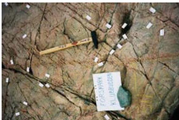
*Fig. 1-1. Photo d'affleurement qui présente un réseau de fractures en 2D, site de Forsmark. Références de l'affleurement : AFM000053 ; Les fractures correspondent aux discontinuités visible dans l'encaissant.*
